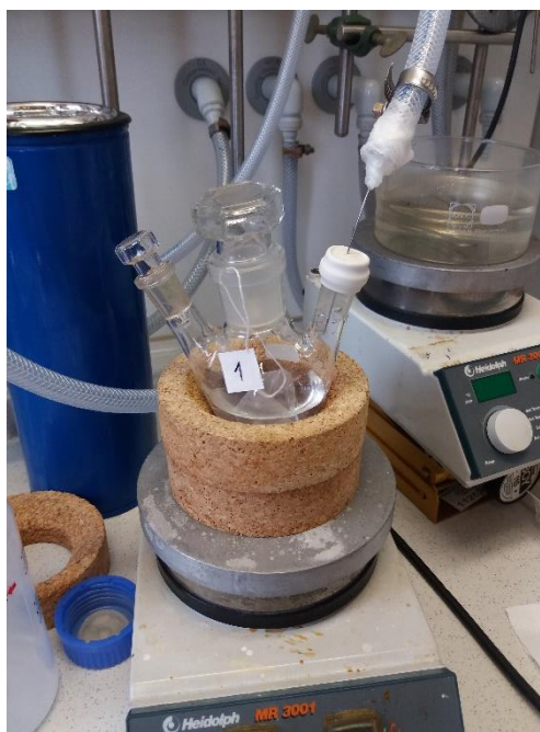
Сурет 16 – Магнийді әртүрлі ерітіндіде ұстауға арналған үшмойынды колба
