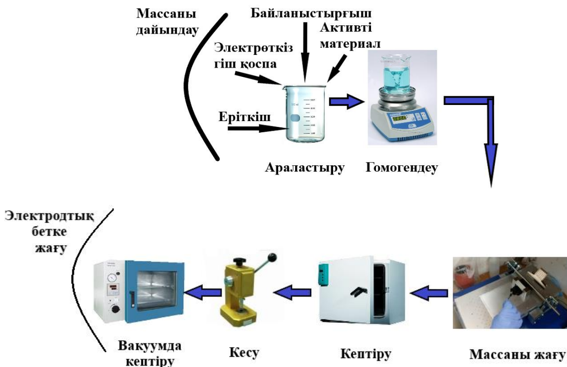
Сурет 20 – Магний-ионды элементтің анодын дайындау схемасы
